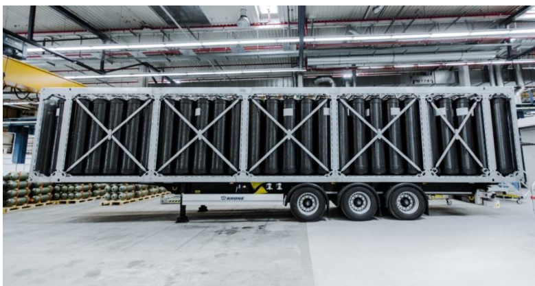
Figuur 2: MEGC Composiet Gascilinders (beeld HexagonPurus)
