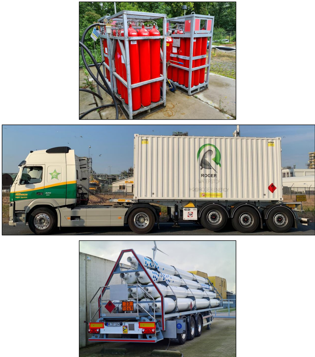
Figuur 6.3 Vormen van opslag. Van boven naar beneden: waterstofbundel, batterijwagen en tubetrailer. De batterijwagen bevat 9 cilinders van 350 bar, de tubetrailer 10 tubes van 200 bar. Foto's: NIPV en Roger Energy.
