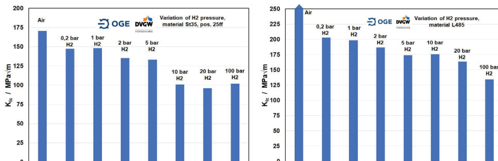
Figuur 9 Invloed van de waterstofdruk op de breuktaaiheid van staalsoorten St37 (links) en L485 (rechts) [19]. De geschatte breuktaaiheid van L485 in lucht is 480 MPa√m.
