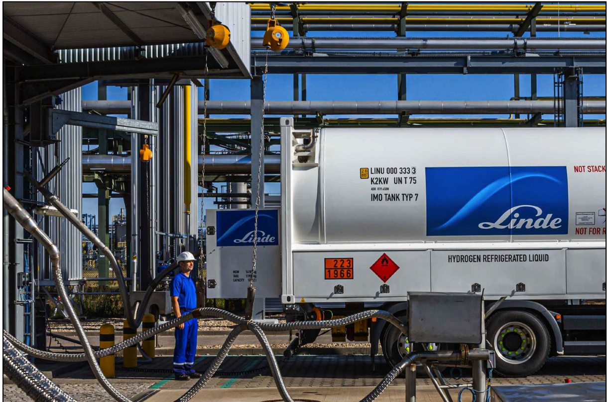
Figuur 3.5 Het laden van gekoeld waterstof op een productielocatie van Linde in Duitsland. Bron: CNBC .
