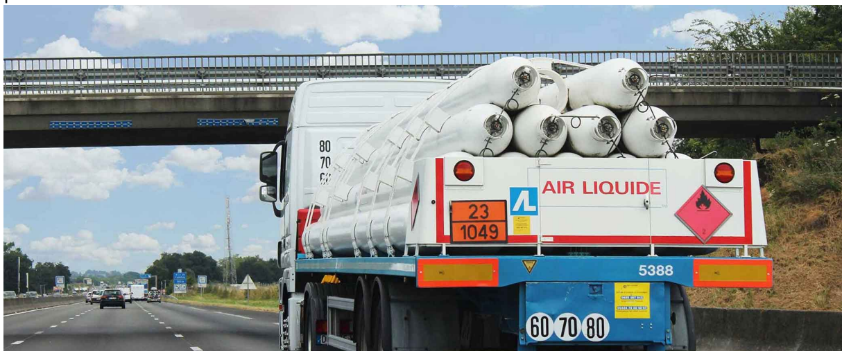
Figuur 3.2 Het transport van gecompriemd waterstof met behulp van een tubetrailer. Bron: Evofenedex .
