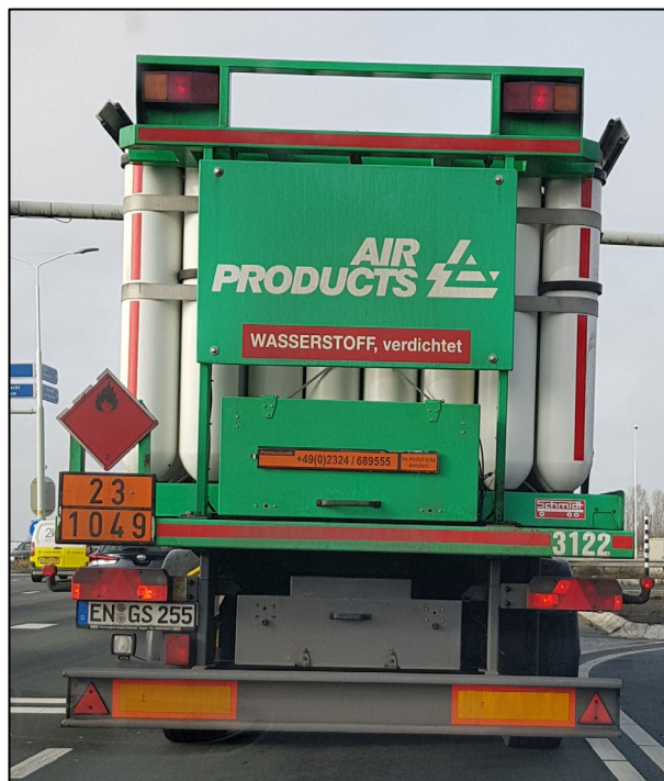
Figuur 3.3 Het transport van gecompriemd waterstof in flessenpakketten.
