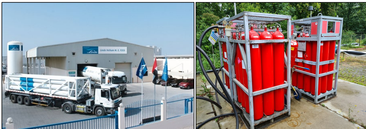
Figuur 4.1 Voorbeelden van een MEGC. Links: tubetrailer, met op de achtergrond een tankoplegger. Rechts: flessenpakket.
